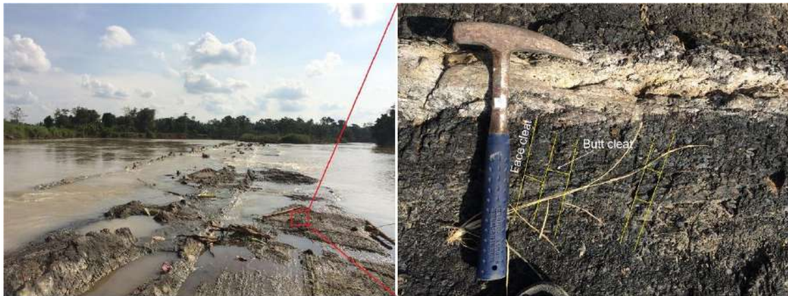
Gambar 10. Lapisan batubara di LP 07 dengan dip 55°, dijumpai sisipan tuffaan
