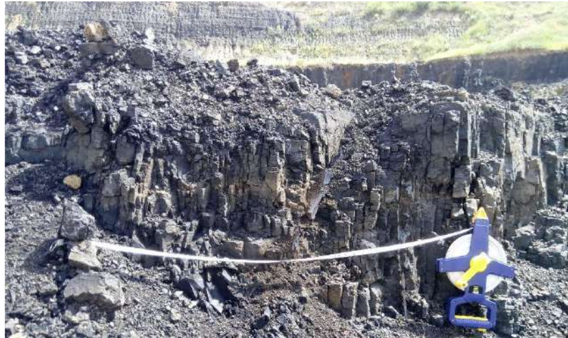
Gambar 9. Pengukuran cleat dengan scanline method pada lokasi telitian.
